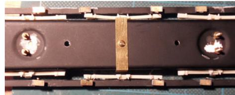
La mise en place des 2 suspensions centrales nécessite de la délicatesse. La caisse est reposée pour pouvoir coller les suspensions centrales. Glissez les suspensions des extrémités autour des cuvettes de roulement et fixez avec une goutte de colle.
