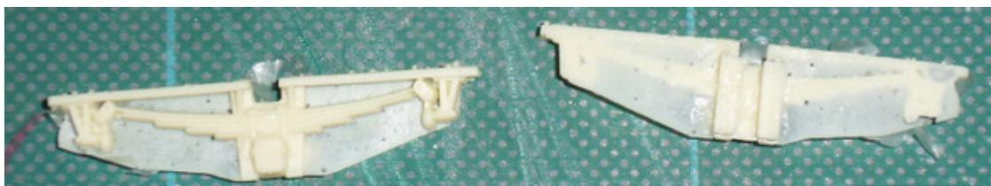
2-1 ) En posant une feuille d'abrasif (80 pour débiter, 120 pour finir) à plat sur une surface ferme et en tenant les suspensions verticalement par la boîte d'essieu, poncez la barre qui n'est nécessaire que pour un moulage de qualité.
