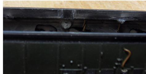
Après séparation de la caisse et du châssis, vous positionnez les suspensions centrales. Vous refixez ensuite la caisse sur le châssis puisque les suspensions devront venir en contact avec la partie du châssis moulée avec la caisse. Collez les suspensions centrales puis positionnez et collez les suspensions d'extrémité.
