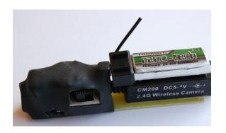
Procéder à des essais de circulation de votre wagon afin de vérifier la bonne réception. Déplacer l'antenne et/ou le récepteur afin de déterminer la meilleure position de réception.
