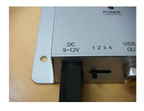
Mettre l'interrupteur de la caméra sur ON : la led verte s'allume et l'image de la caméra apparaît sur le téléviseur (si ce n'est pas le cas, vérifier le canal de la caméra et celui du récepteur ou si l'entrée VIDEO du téléviseur est bien sélectionnée).
