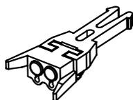
Cet nouvel attelage a pour but d'apporter une grande simplicité d'utilisation avec un accouplement possible en courbe et un dételage manuel par simple traction entre les deux véhicules.
