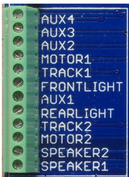
Photo 2 : Bornier à vis pour décodeurs sans connecteur.
