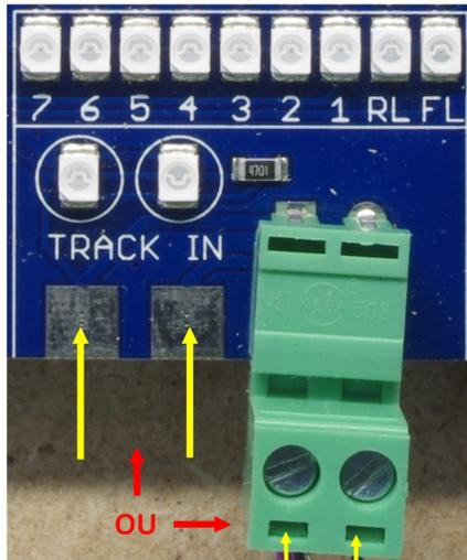
Photo 3 : Raccordement par vis ou par contacts à souder pour la liaison vers le centrale numérique.
